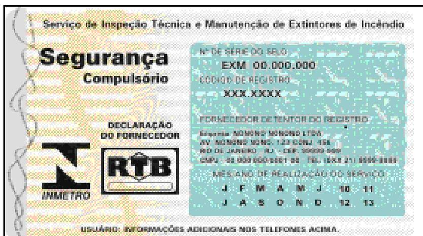
**Figura 5 - Modelo de selo de identificação da conformidade do Inmetro**
