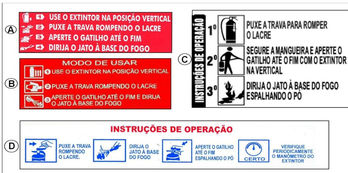
**Figura 8 - Quadros de instruções presentes nos extintores do tipo pó químico BC ensaiados**
