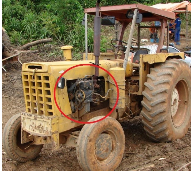
Fotografia 3 – Polia sem proteção com perigo de acidentes Fonte: Autoria própria.
