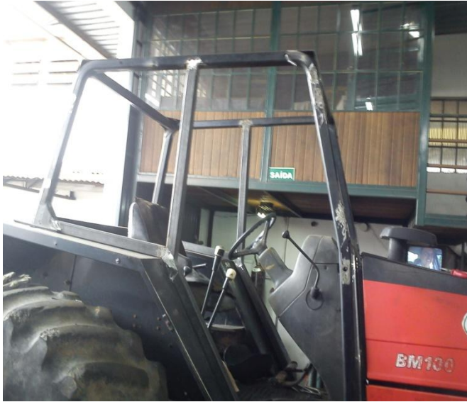
Fotografia 4 – Montagem de uma estrutura de proteção contra capotamento
