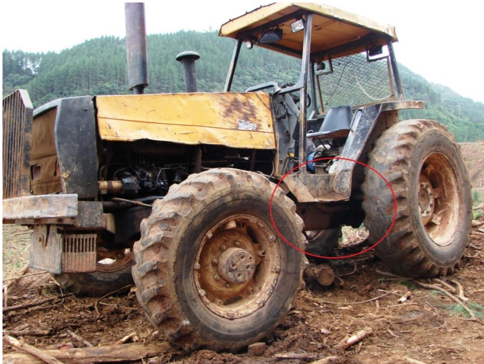
Fotografia 2 – Escada fora das normas e equipamento e má conservação Fonte: Autoria própria.
