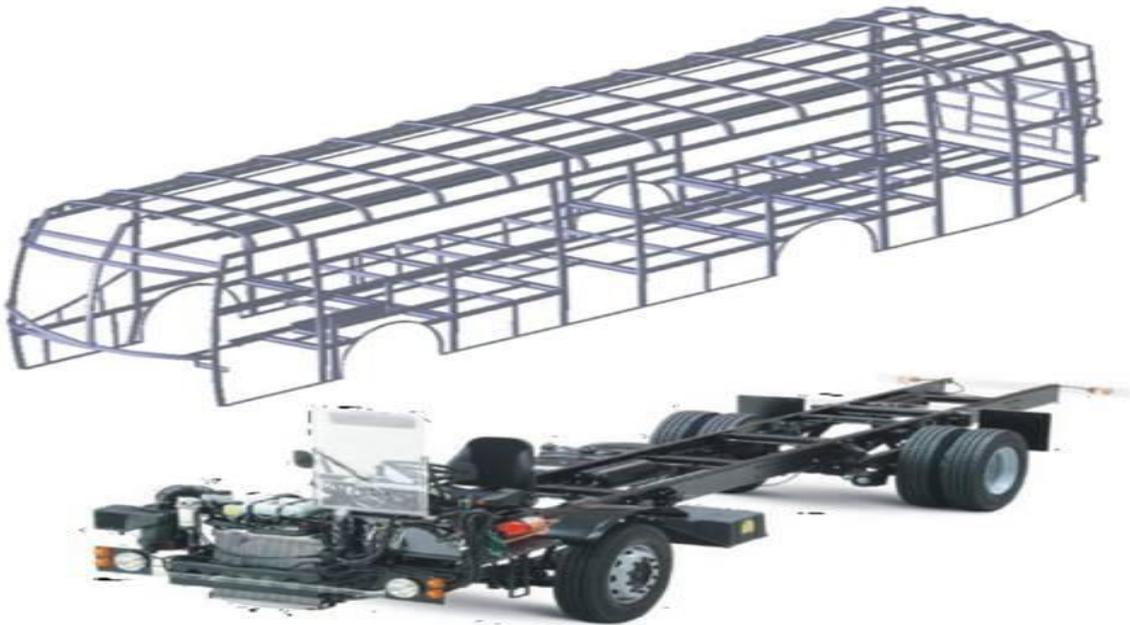
Figura 6 – Desenho esquemático da carroceria e estrutura do ônibus.
