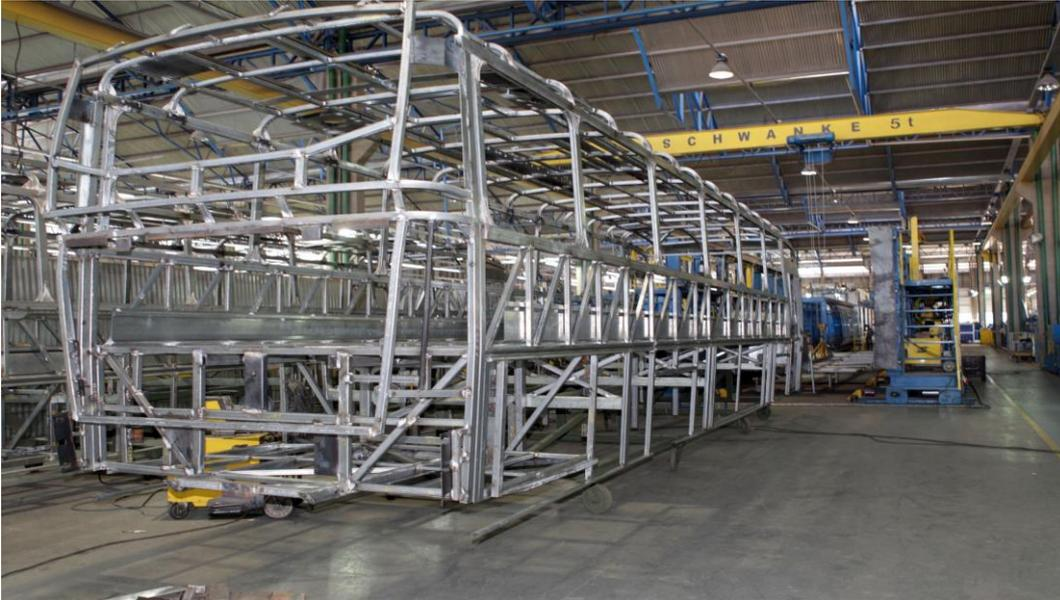
Figura 7 – Imagem da linha de produção da estrutura do ônibus.
