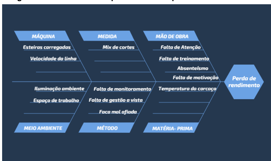
Figura 3 - Diagrama de causa e efeito para análise da perda de rendimento na sala de cortes
