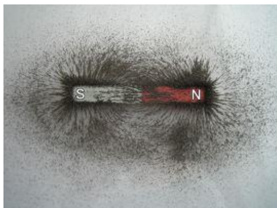
Figura 17 – A disposição da limalha de ferro permite a visualização das linhas de campo magnético geradas pelo ímã de barra. Fonte: web 10
