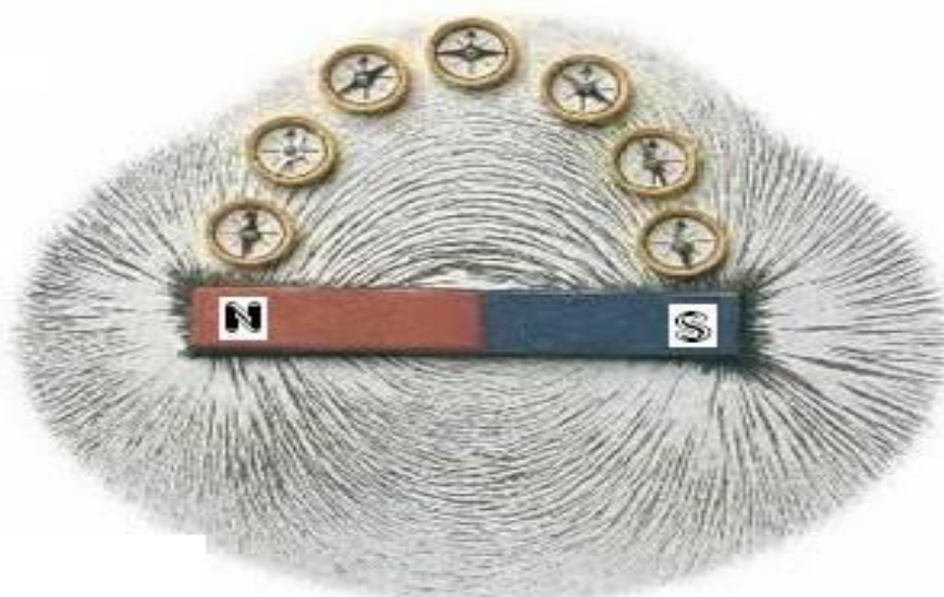
Figura 16 – As agulhas imantadas das bússolas estão sujeitas à ação do campo magnético do ímã, sendo por isso desviadas de sua posição original. Fonte: web 9.
