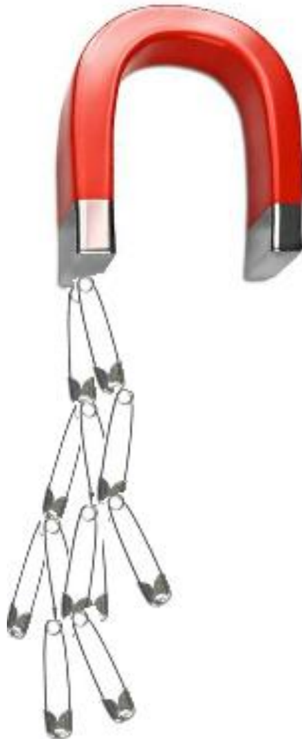
Figura 15 – Alfinetes de aço são atraídos por um ímã em forma de ferradura. Há imantação induzida pelo ímã de tal modo que cada alfinete se torna um pequeno ímã que magnetiza seu vizinho. Os alfinetes permanecem magnetizados por pouco tempo após o ímã ser removido. Fonte: autoria própria.
