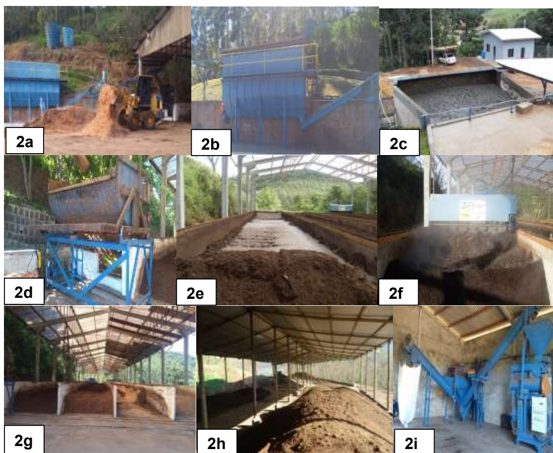
Figura 02: Fases do processo de compostagem: recebimento de serragem (2a), tula de recebimento de lodo (2b) (2c), caçamba distribuidora de lodo (3d), lodo distribuído sobre os vãos de compostagem (2e), equipamento revolvedor (2f), vãos de compostagem (2g), composto em maturação (2h) e equipamentos beneficiamento e ensaque (2i).
