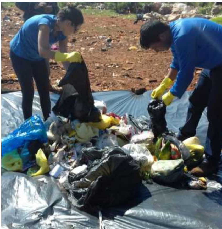
Figura 6: Abertura das Embalagens de Acondicionamento e Despejo dos RUSs Sobre a Lona para o Revolvimento. Fonte: Prefeitura de Santa Mariana, 2017.
