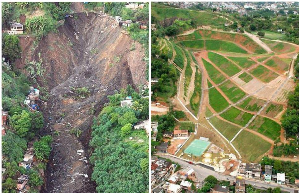
**Figura 9. Imagem aérea das obras de reconstrução feitas após o escorregamento no morro do Bumba em Niterói/RJ para o escoamento de água das chuvas, dreno e coleta de chorume.**
