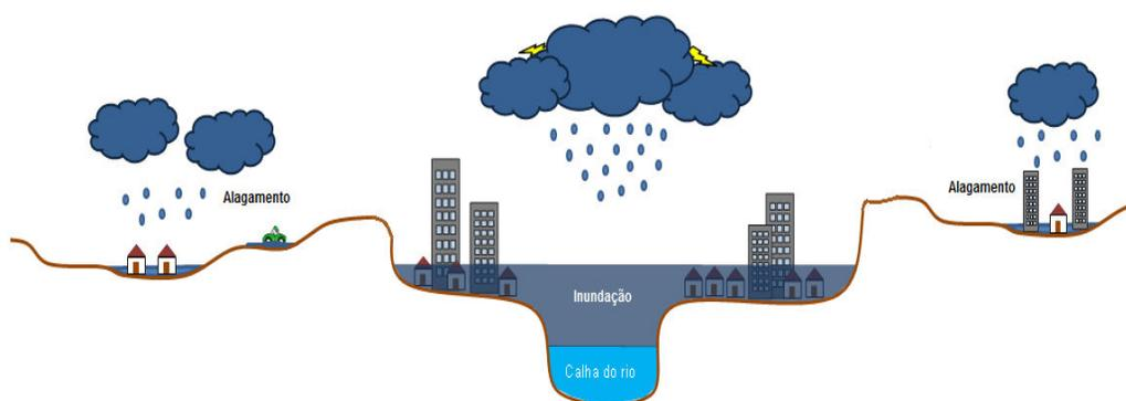
**Figura 4 – Diferenciação entre inundação e alagamento**
