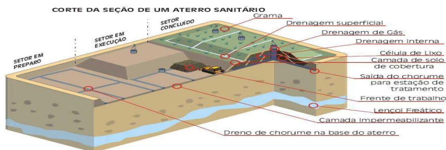
Figura 05: Corte da Seção de um Aterro Sanitário. Fonte: Saojoaodelreitransparente.com.br/2015.
