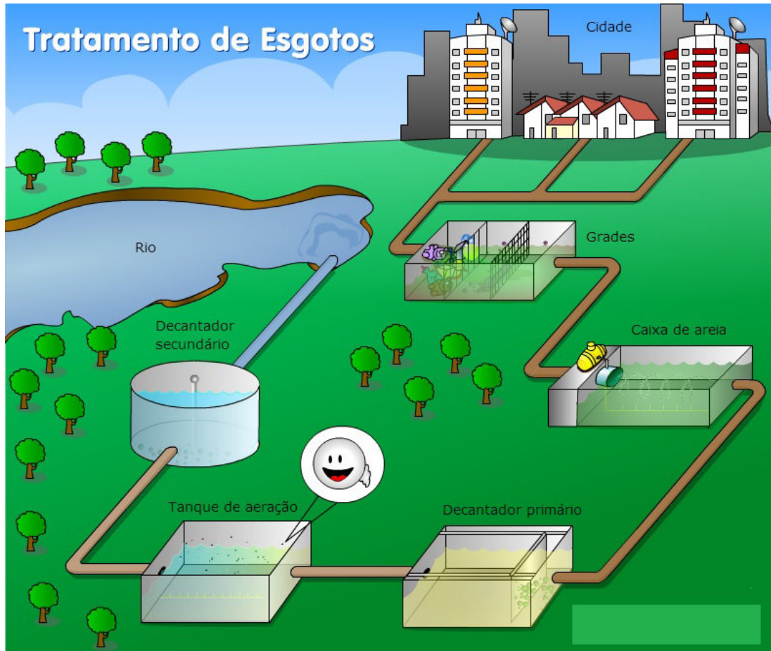
Figura 4 – Exemplo de configuração de uma ETE para águas residuárias. SABESP, 2015.
