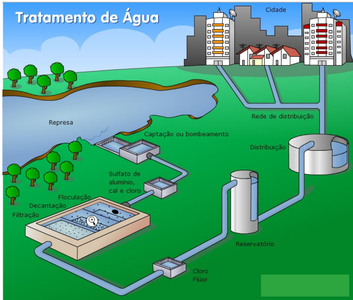
Figura 2 - Fases do tratamento de água.
