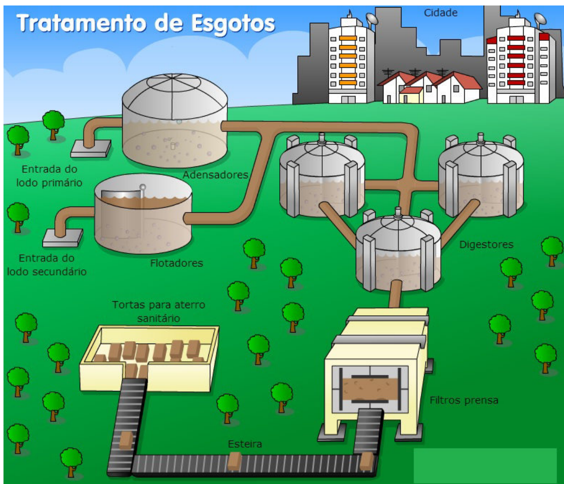
Figura 5 - Fases sólida do tratamento do esgoto. SABESP, 2015
