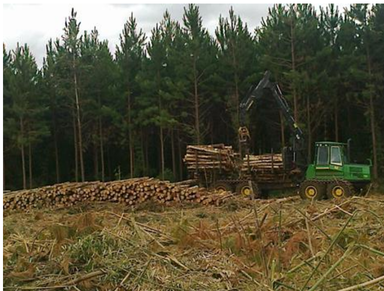
Figura 14 - Operação de empilhamento com Forwarder. Fonte: Autor.
