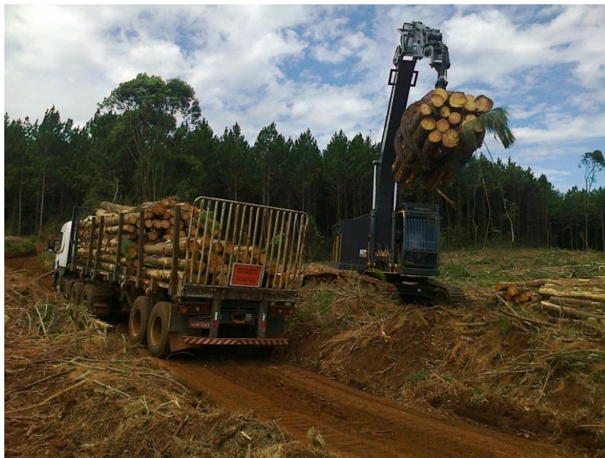
Figura 15 - Operação de carregamento com Grua Carregadeira. Fonte: Autor.
