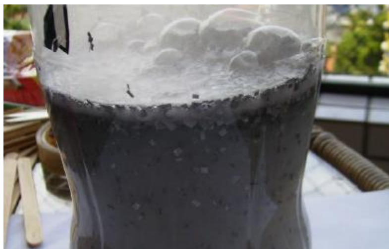
Figura 09.- Aspecto do reator com geração de Hidrogênio gasoso
