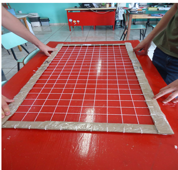
Figura 5 - Rede retangular quadriculada utilizada na coleta de campo pelos alunos. Fonte: Material fotográfico do Colégio Passos Firmes – Matelândia PR.
