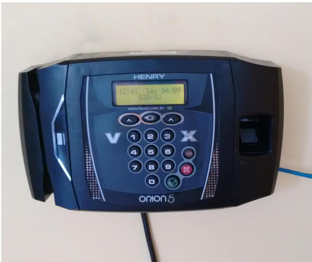
**Fotografia 1:** Relógio Henry. Este relógio tem leitor biométrico, de crachá, ponto de rede e pen-drive embutido.
