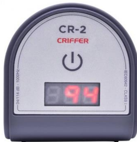
Figura 12 – Calibrador acústico da CRIFER modelo CR-2 Fonte: Próprio autor
