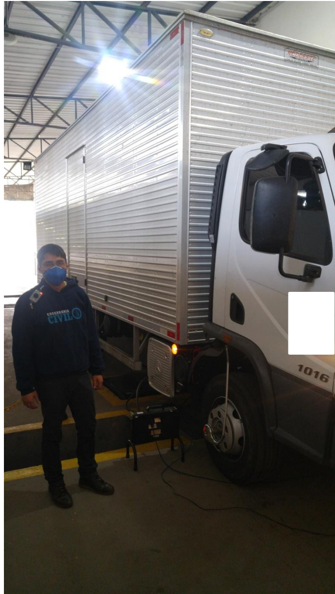
Figura 10 – Técnico realizando análise de opacidade em um caminhão Fonte: Próprio autor
