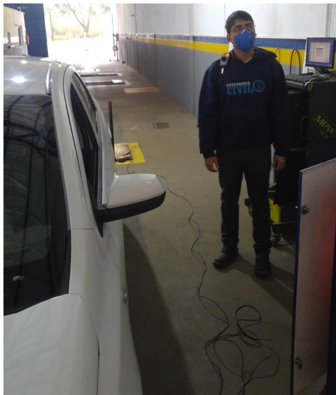
Figura 8 – Técnico realizando análise de gases em um veículo Fonte: Próprio autor
