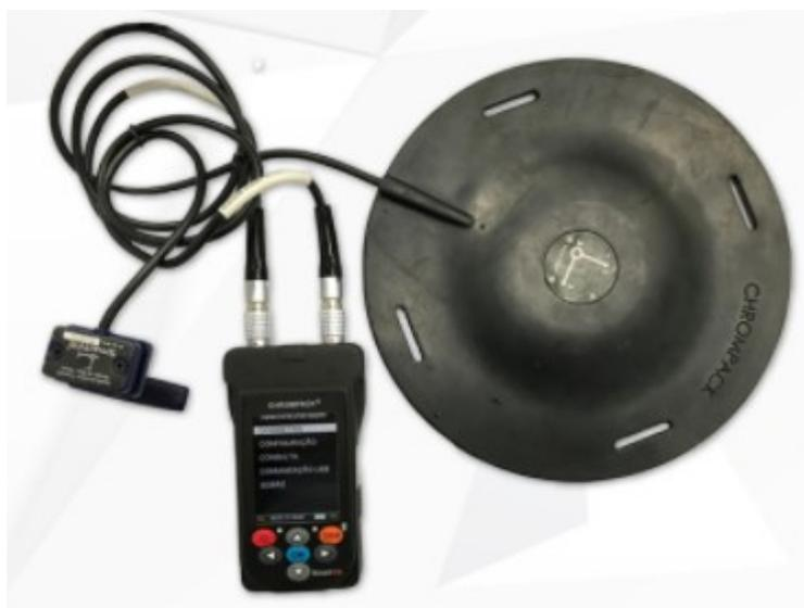
**Fotografia 6 – Acelerômetro SmartVib**
