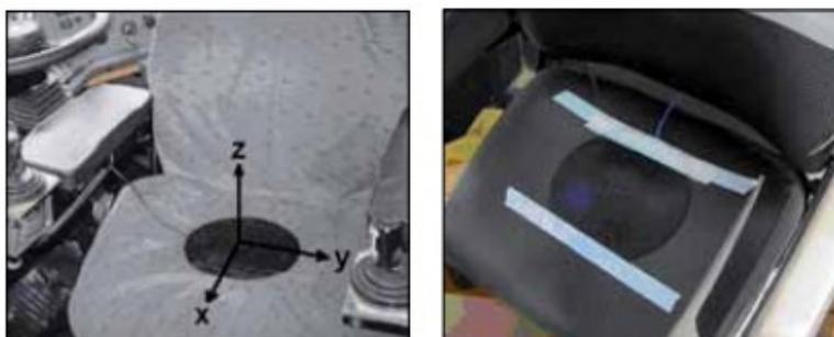
Fotografia 2 – Posicionamento do sensor VCI
