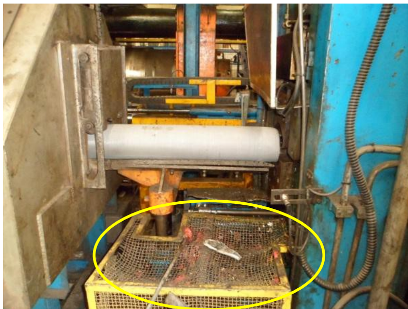
Fotografia 3 – Área de Prensagem com Proteção Fixa (Tela) Precária
