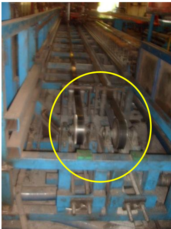
Fotografia 31 – Lateral Esquerda do Conjunto Prensa: Corredor de Acesso: Partes Móveis Expostas
