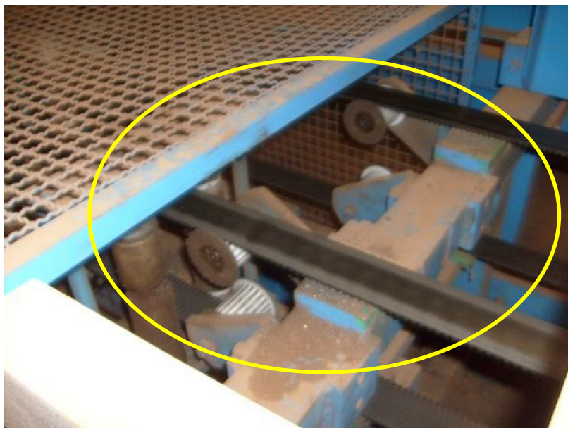
Fotografia 29 – Conjunto de Apoio e Controle dos Carros Transportadores: Partes Móveis Expostas
