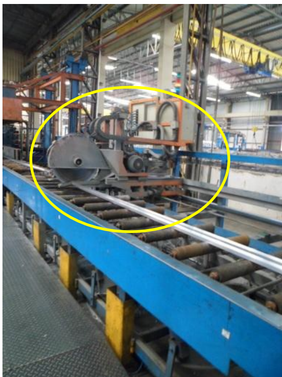
Fotografia 32 – Serra Circular Instalada Conjuntamente ao Carro Transportador
