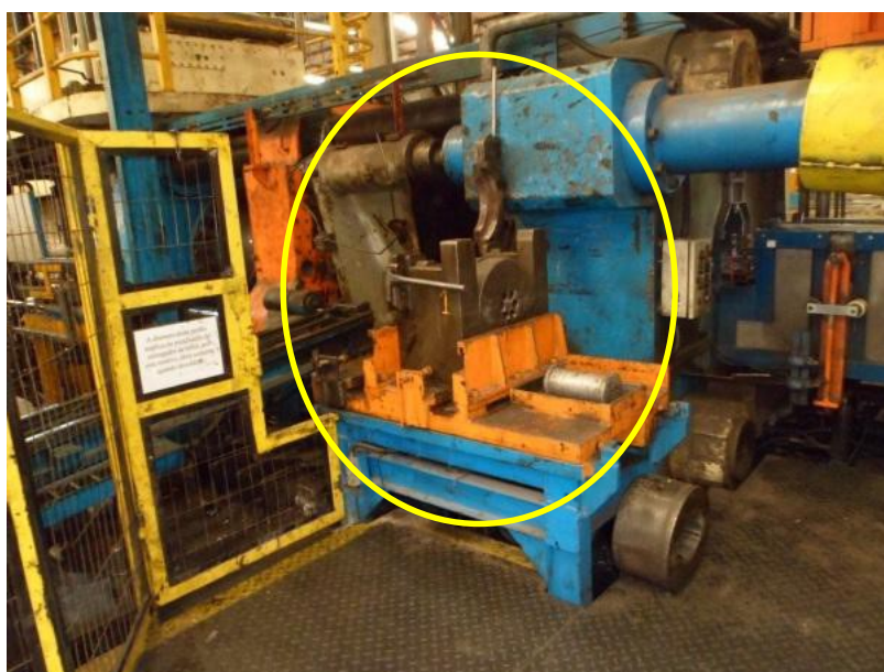
Fotografia 2 – Área de Prensagem – Cilindros Hidráulicos Potentes Expostos
