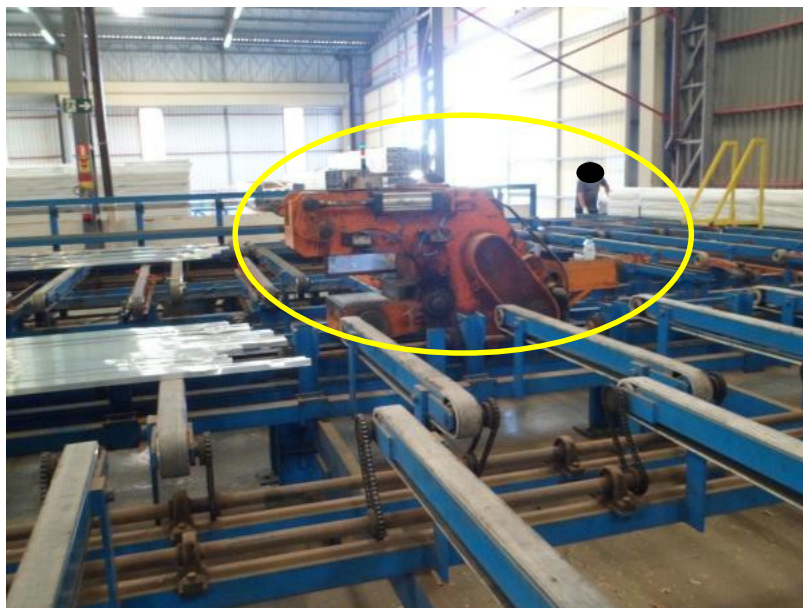
Fotografia 37 – Esticador de Perfis: Partes Móveis Expostas: Vista Lateral Direita
