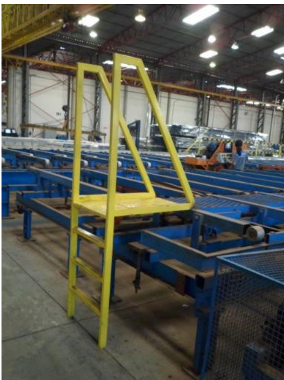
Fotografia 44 – Escada de Acesso Plataforma de Apoio de Perfis
