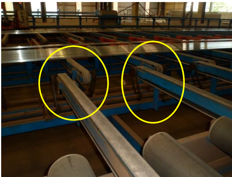
Fotografia 41 – Vista Lateral da Plataforma de Apoio de Perfis: Zona de Risco e Partes Expostas (C)
