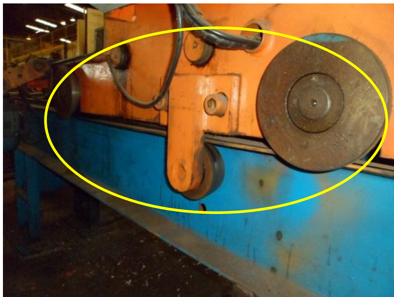
Fotografia 35 – Esticador de Perfis: Partes Móveis Expostas Vista Lateral Esquerda (B)
