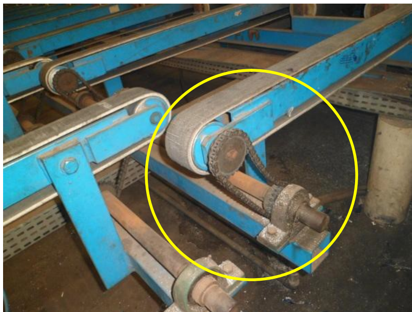
Fotografia 39 – Vista Lateral da Plataforma de Apoio de Perfis: Zona de Risco e Partes Expostas (A)
