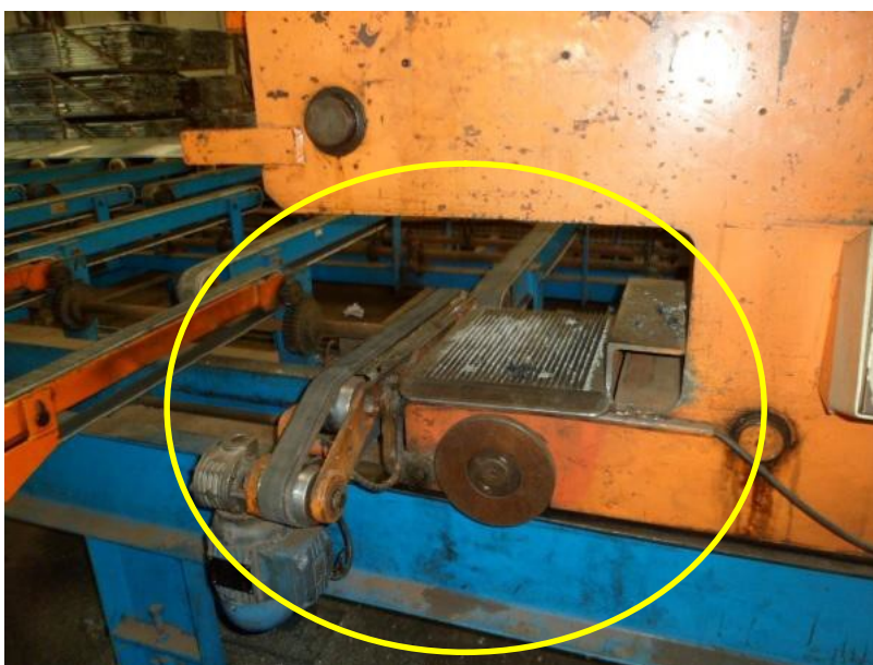
Fotografia 34 – Esticador de Perfis: Partes Móveis Expostas Vista Lateral Esquerda (A)
