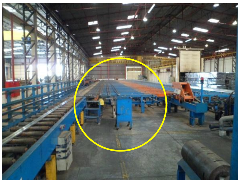
Fotografia 38 – Plataforma de Apoio de Perfis
