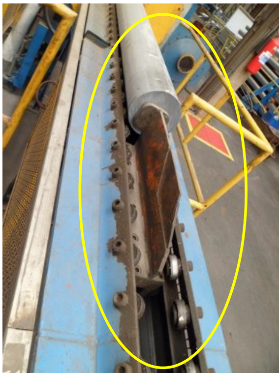
Fotografia 11 – Alimentador Automático de Tarugos de Alumínio: Canaleta Pneumática
