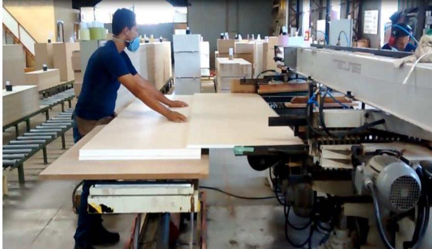
Fotografia 4. Posicionamento do processo inicial de perfuração.
