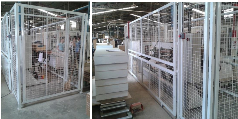
Fotografia 7- Fechamento de toda as laterais da furadeira múltipla com estrutura telada.
