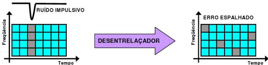
Figura 22 - Entrelaçamento no tempo contra o ruído impulsivo Fonte: Egberto (2008)
