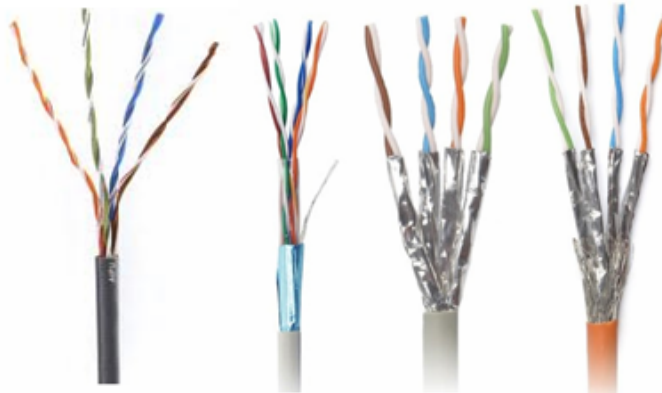
Figura 4 – Exemplo de cabo UTP, FTP, STP e SSTP Fonte: Morimoto, 2013
