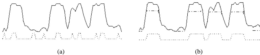
Figura 33: Exemplo aplicação da transformada de h-máximos. A linha pontilhada na parte inferior da figura mostra a localização dos máximos (VACHIER; MEYER, 1995).
