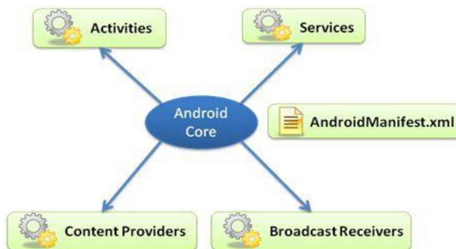
Figura 4: Componentes de uma aplicação Android. Fonte: Conhecendo o Android.
