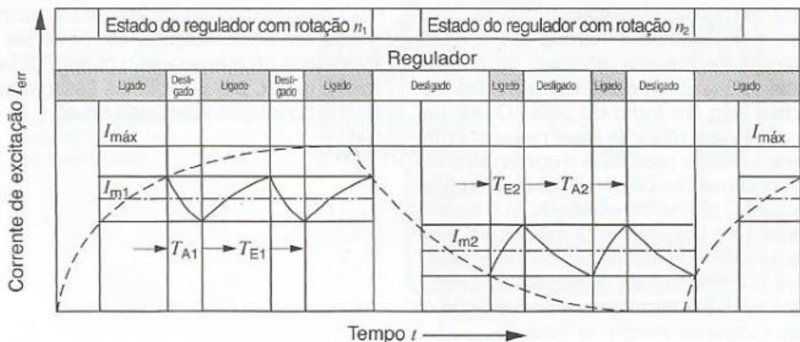
Figura 13 – Curva característica da corrente de excitação do alternador
