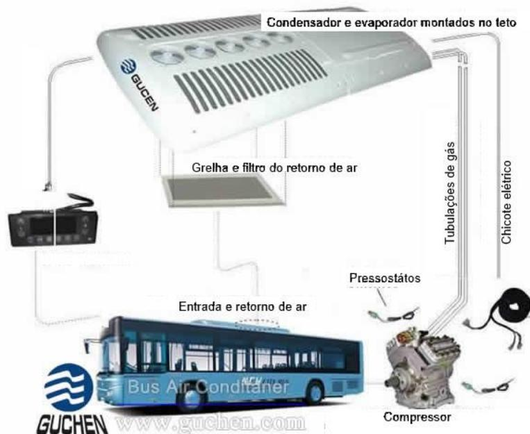
Figura 2: Componentes de um sistema de ar condicionado para ônibus
