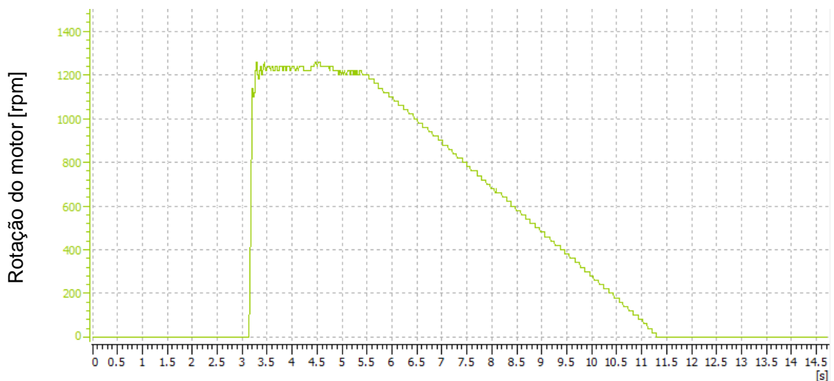
Figura 25 – Rampa de aceleração e desaceleração Fonte: Autor, 2015.
