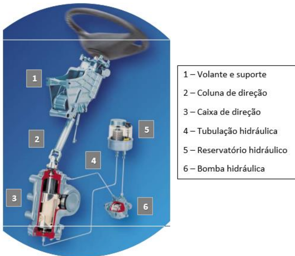
Figura 4 – Sistema convencional de direção hidráulica Fonte: Adaptado ZF Steering Systems for Commercial Vehicles, 2015.
