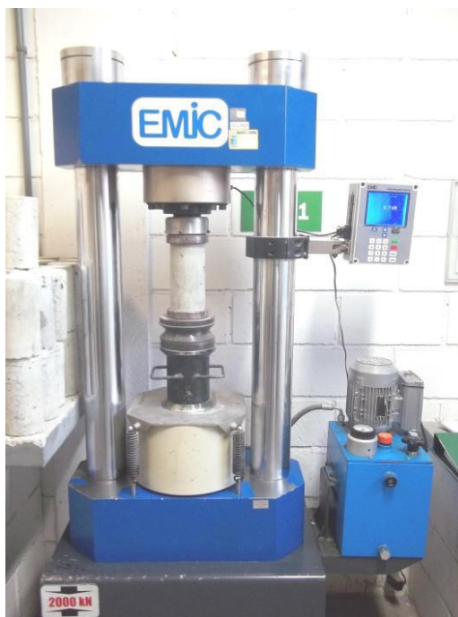
Figura 14 – Prensa utilizada para rompimento dos corpos de prova
