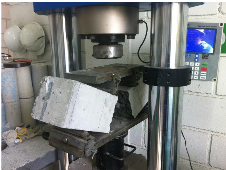
Figura 15 – Detalhe de um rompimento de um prisma de concreto
