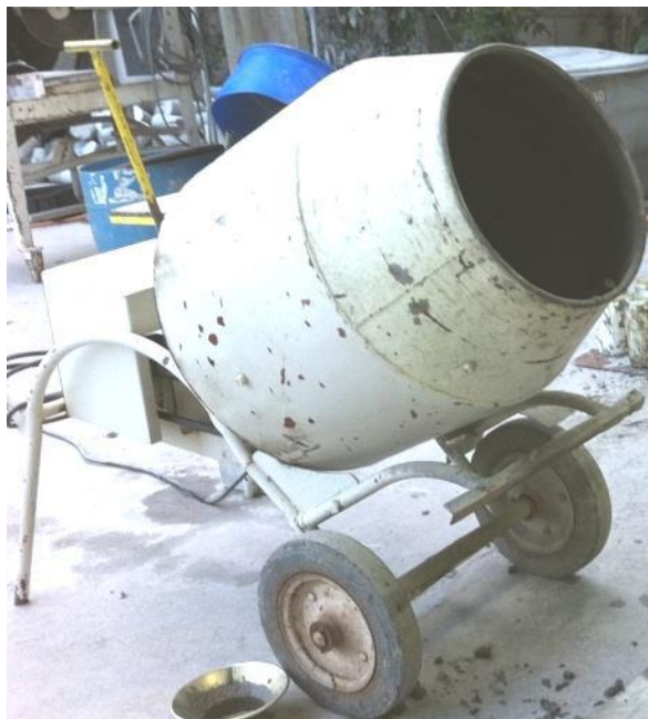
Figura 10 – Betoneira com capacidade para 50l utilizada para confecção do concreto
