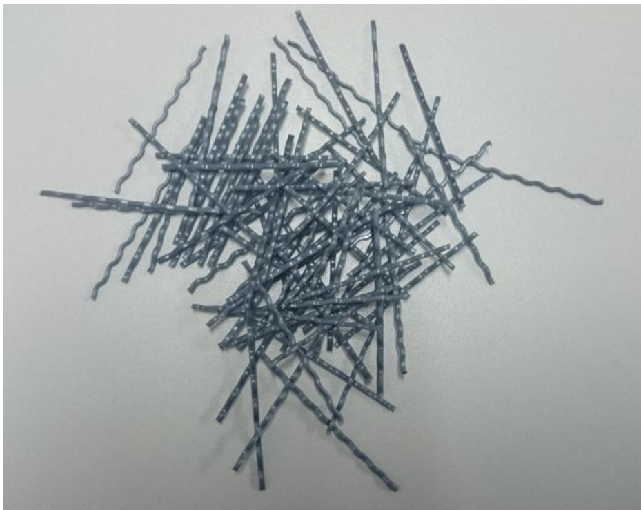
Figura 6 – Fibra de Polipropileno estrutural utilizada no estudo (FONTE: Cia. de Cimento Itambé)
