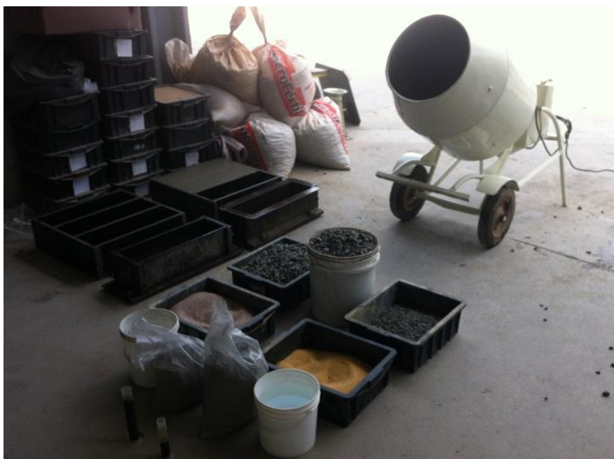
Figura 8 – Dosagem de concreto (materiais pesados, prismas moldados e betoneira utilizada)
