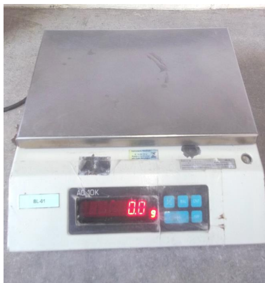
Figura 11 – Balança digital com resolução de 1g para pesagem de cimento, água e aditivos
