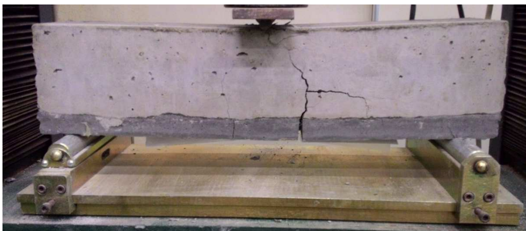
Figura 16 – Alt. 3 – V1 - CPR na região de tração com ponte de aderência em resina sintética
