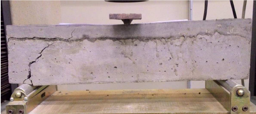
Figura 14 – Alt. 2 – V2 - CPR na região de compressão com ponte de aderência em resina sintética
