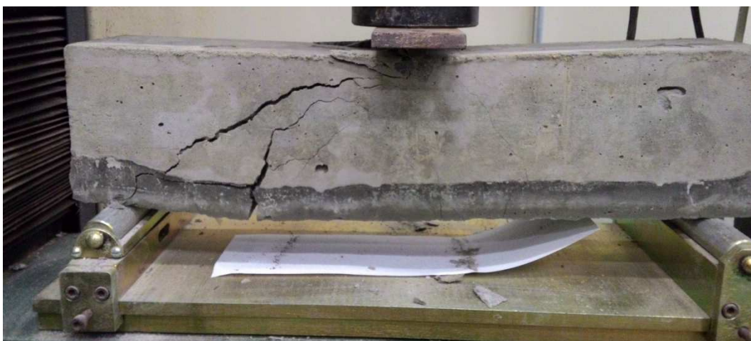
Figura 22 – Alt. 5 – V2 - CPR na região de tração sem ponte de aderência em resina sintética
