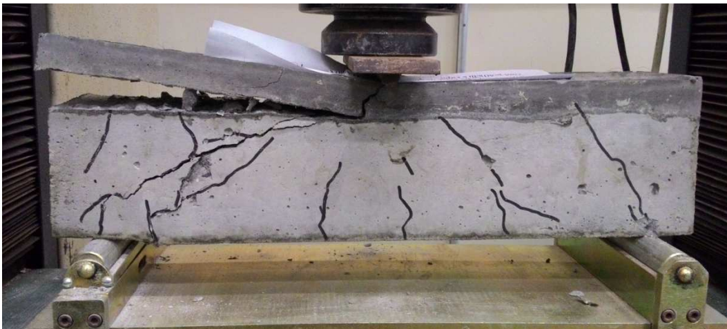
Figura 15 – Alt. 2 – V3 - CPR na região de compressão com ponte de aderência em resina sintética
