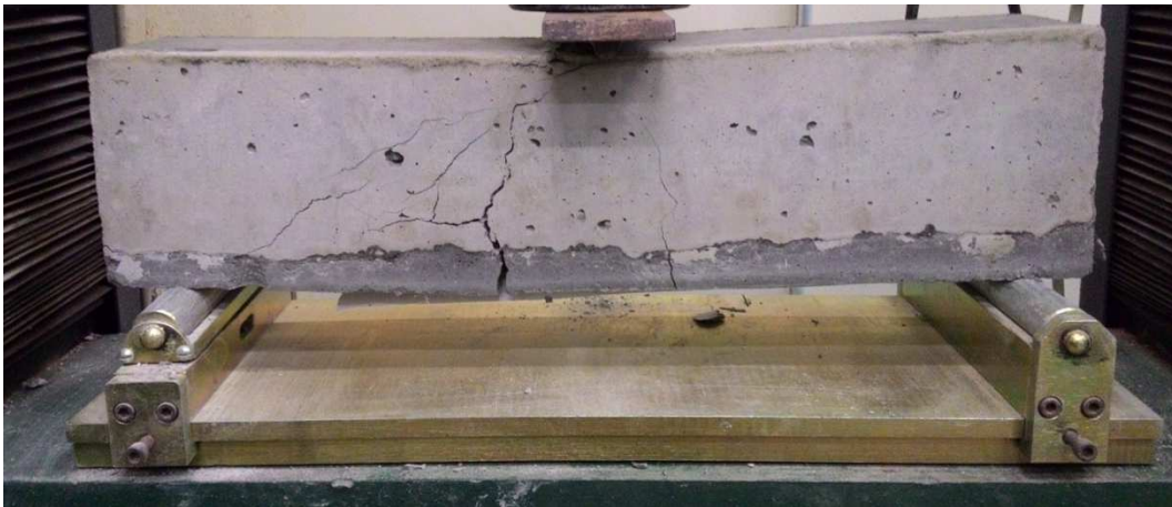
Figura 21 –Alt. 5 – V1 - CPR na região de tração sem ponte de aderência em resina sintética
