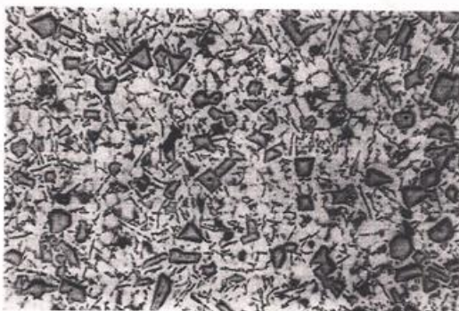
Figura 3 – Partículas de silício em amostra da liga 390 com aproximadamente 15% Si, após adição de 0,03% P. Sem ataque químico. Fonte: BACKERUD, et. al., 1990, p.26.
