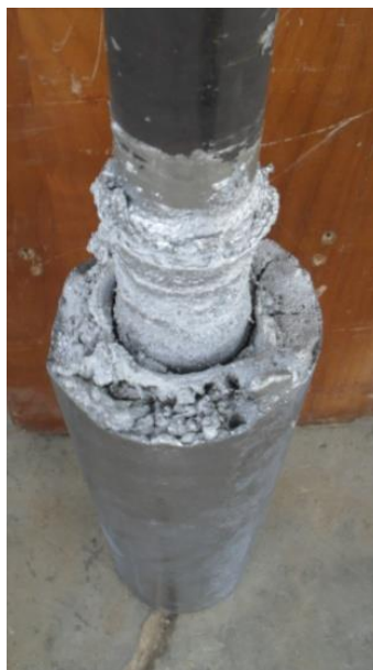
Figura 42 – Lingote obtido por solidificação outward mais tubo trocador de calor (substrato de aço carbono) Fonte: O Autor
