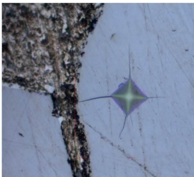
Figura 60. Fissuras geradas por indentação mostrando a fragilidade do intermetálico \alpha\text{-Al}_{15}(\text{Fe,Mn,Cr})_4\text{Si}_2 .
