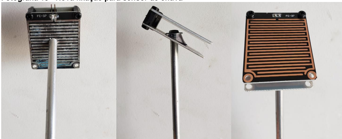
Fotografia 19 - Nova fixação para sensor de chuva
