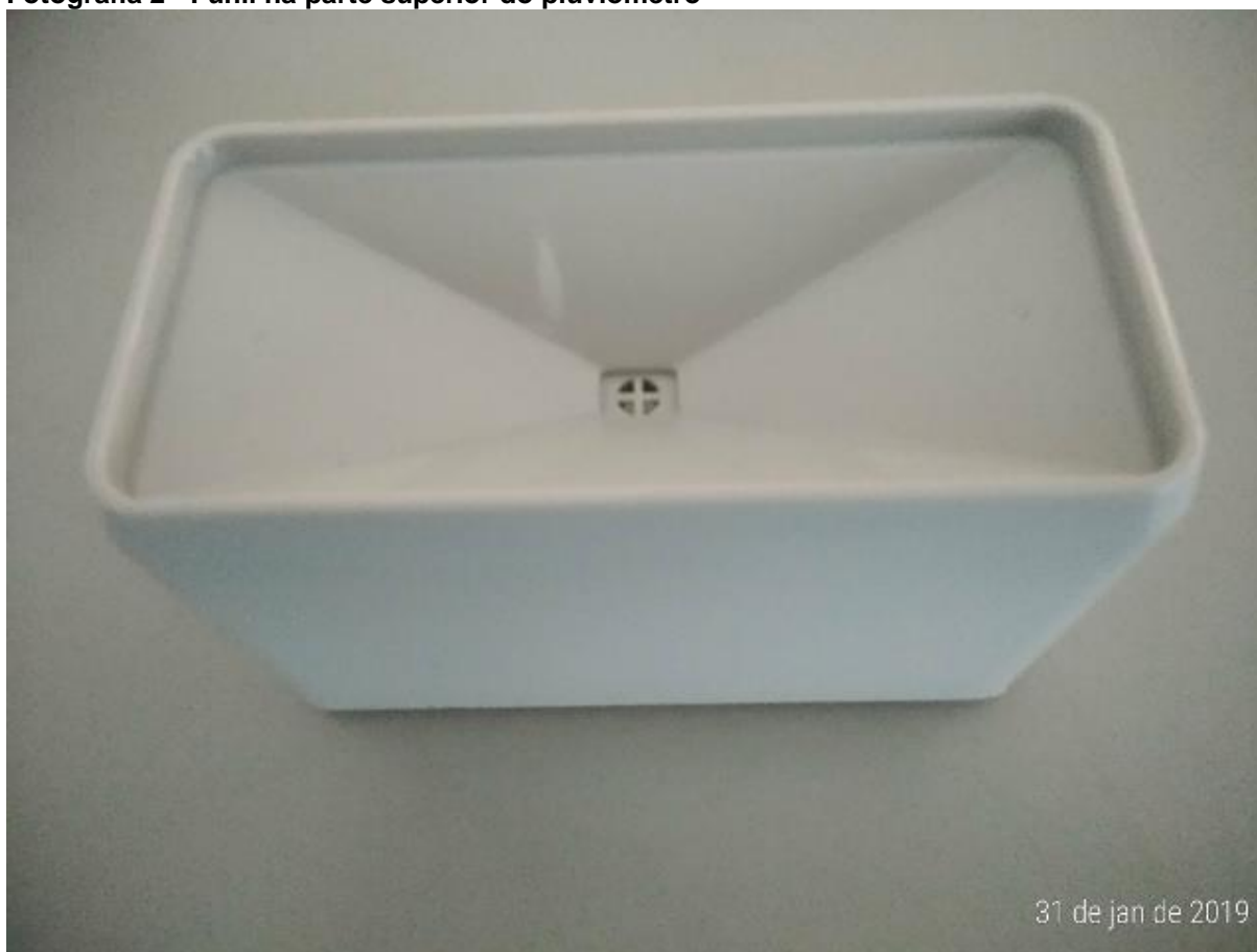
Fotografia 2 - Funil na parte superior do pluviômetro
