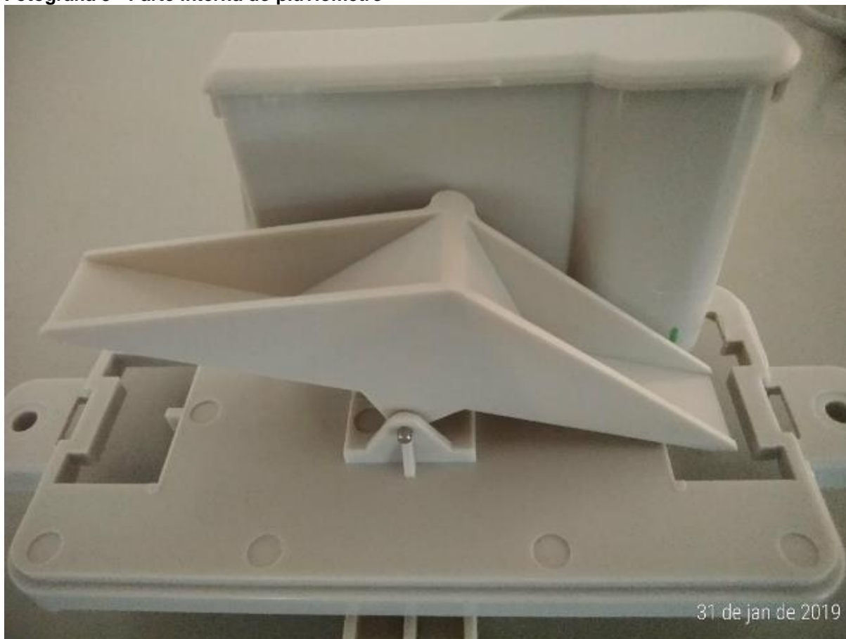
Fotografia 3 - Parte interna do pluviômetro
