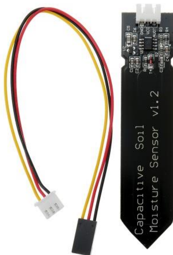
Fotografia 4 - Sensor capacitivo de umidade do solo
