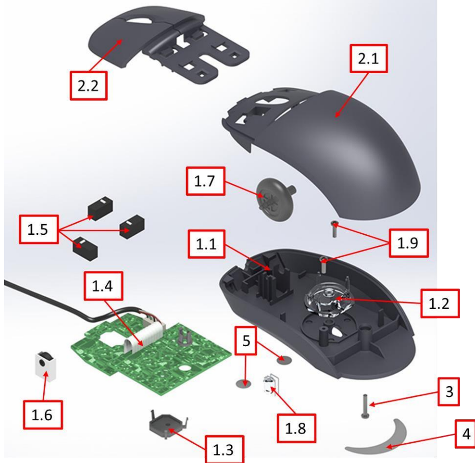
Figura 7 – Vista explodida, com indicação dos componentes, do mouse
