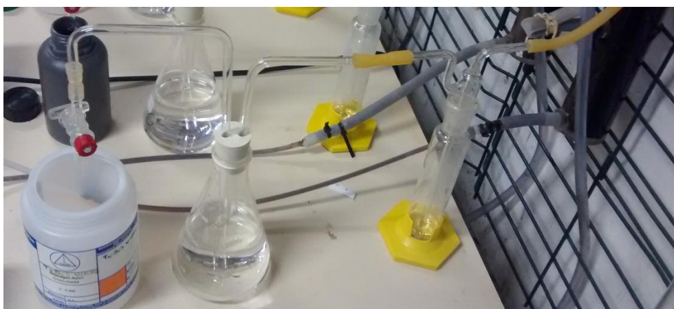
Foto 2 - Sistema para medição do volume de metano produzido
