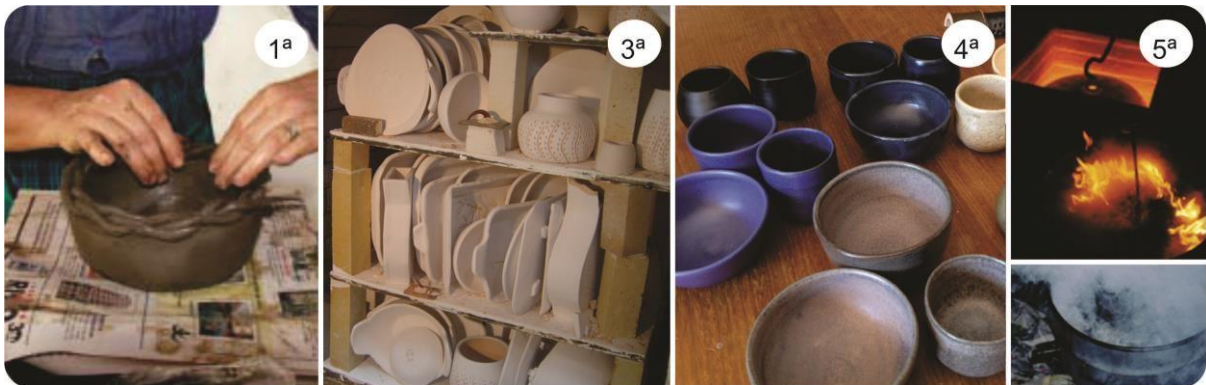
Figura 8 - Imagens que exemplificam o processo de produção das bailarinas (etapas 1, 3, 4 e 5). Fonte: AGITA PIRENÓPOLIS (2011), ATELIER KOLIBER (2012), MAREN YUMI (2014) e LACAD (2014).
