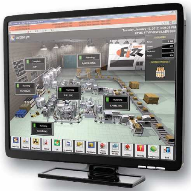
Figura 8 – Tela Supervisório Factory talk Fonte: Rockwell Automation (2013)
