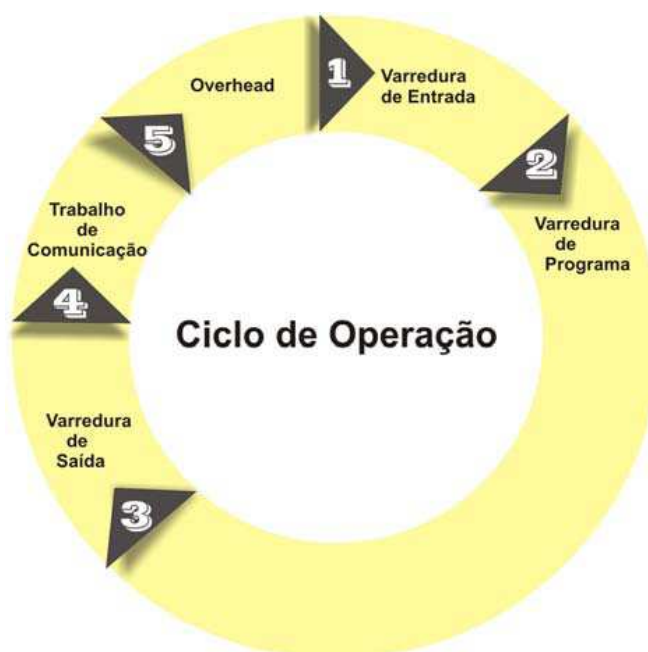
Figura 3 - Princípio de funcionamento de um CLP Fonte: Bradley (2006)
