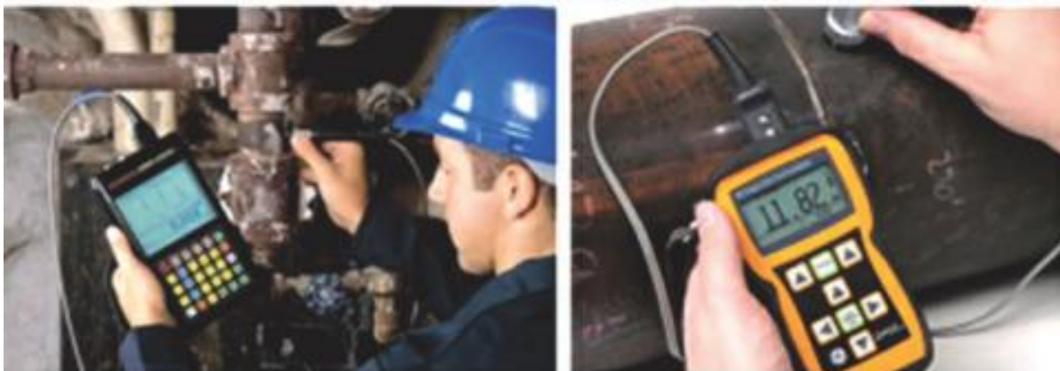
Figura 35 - Medidores de espessura
