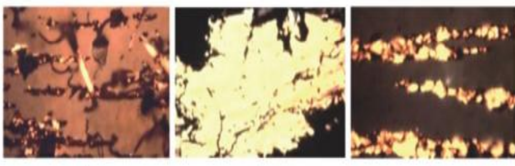
Figura 32 - Exemplos de ferrogramas
