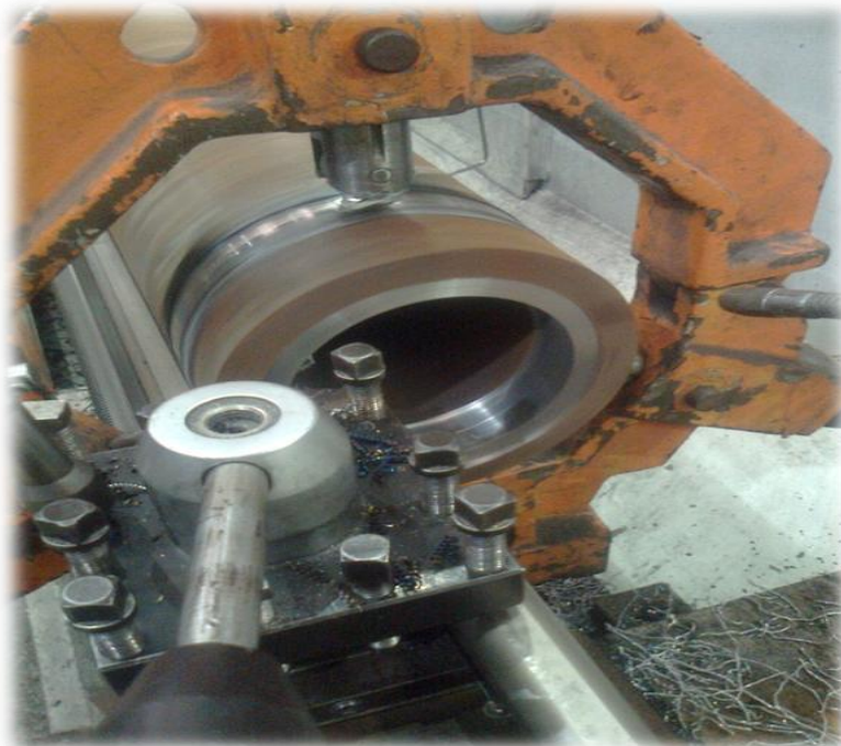
Figura 71 - Usinagem do tubo principal
