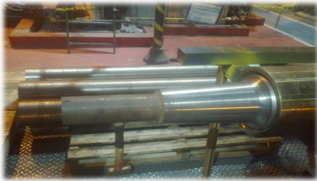
Figura 73 - Rolo montado aguardando solda
