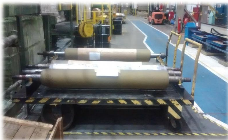
Figura 2 - Rolos revestidos aguardando instalação
