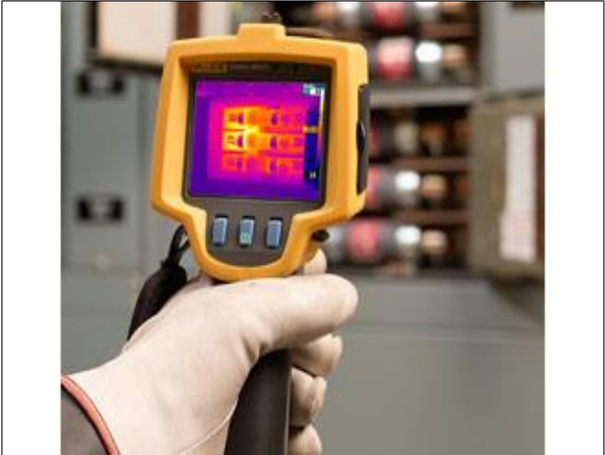
FIGURA 05 - CÂMERA TERMOGRÁFICA UTILIZADA FLUKE TI 10 FONTE: O AUTOR
