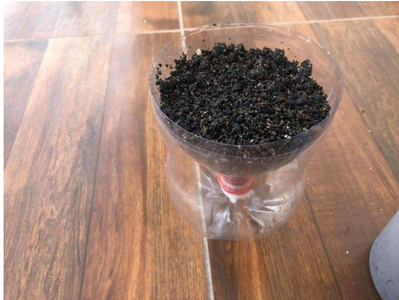
Figura 38- Ensaio caseiro de permeabilidade do substrato
