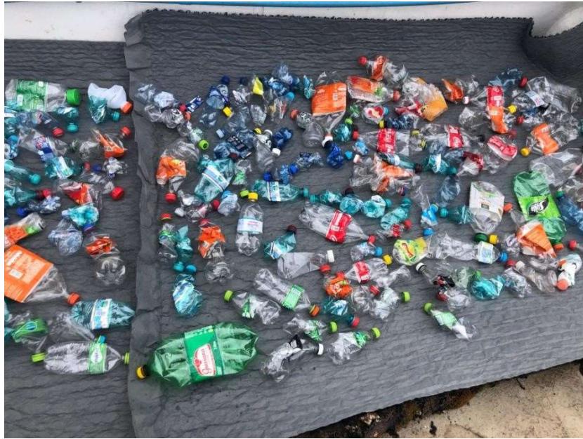
Figura 26- Macdrain J e espalhamento das garrafas PET
