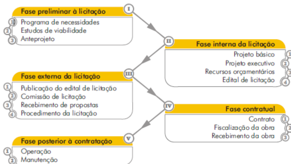
Figura 1 – Fluxograma de procedimentos Fonte: TCU (2013, p. 12).
