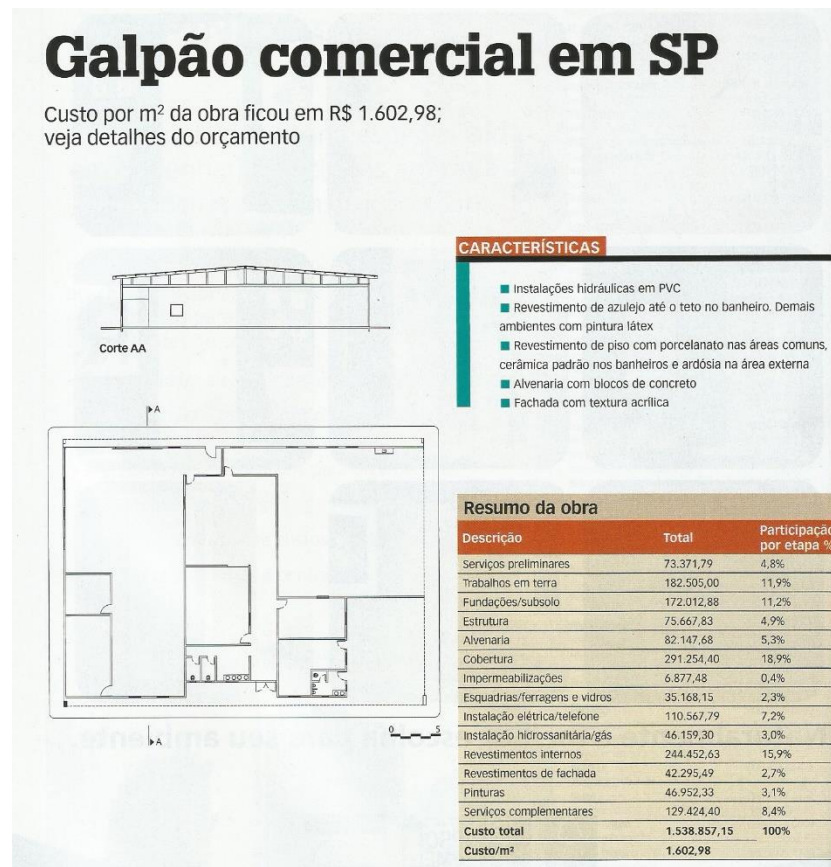
Figura 1 – Detalhes da obra para a comparação
