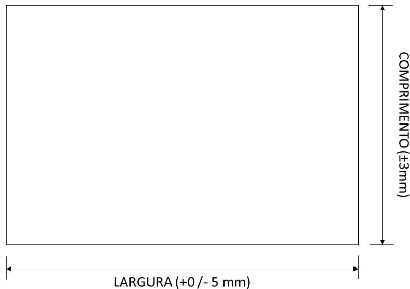
Figura 4 – Desenho de uma chapa blanc
