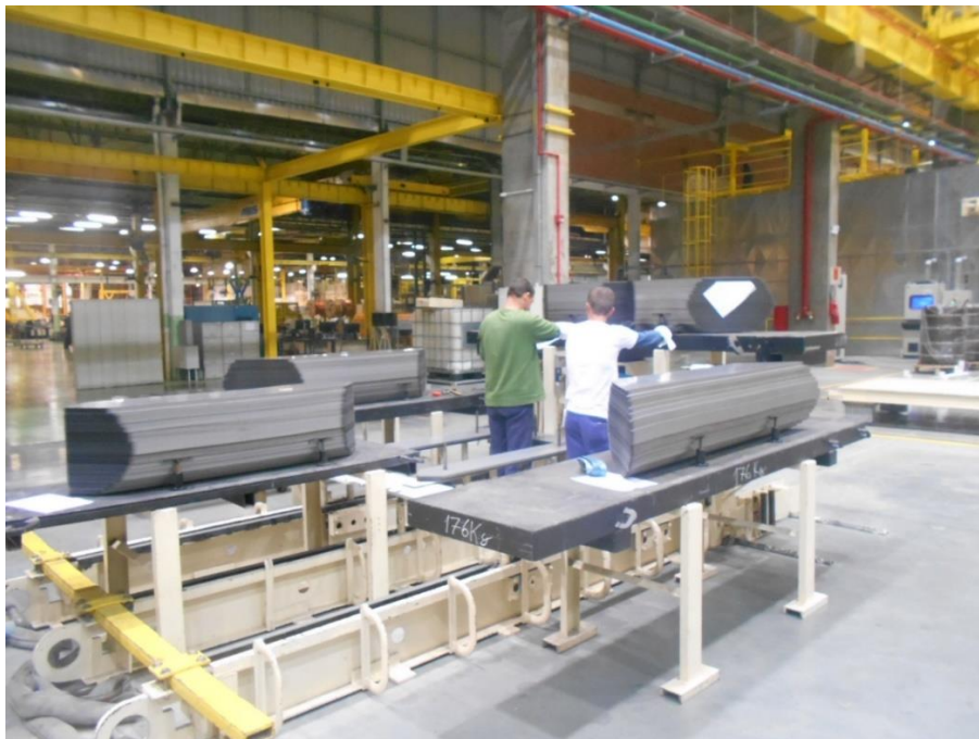
Figura 13 - Processo de montagem dos núcleos de transformador Fonte: Autoria própria.
