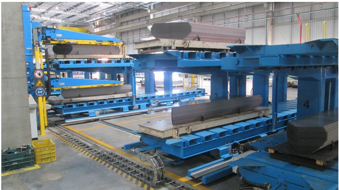
Figura 11 - Sistema de empilhamento das chapas na máquina de corte transversal Fonte: Autoria própria.
