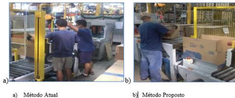
Figura 13a) Dois operadores embalando o motor. b) Um operador embalando o motor Fonte: Autoria própria.
