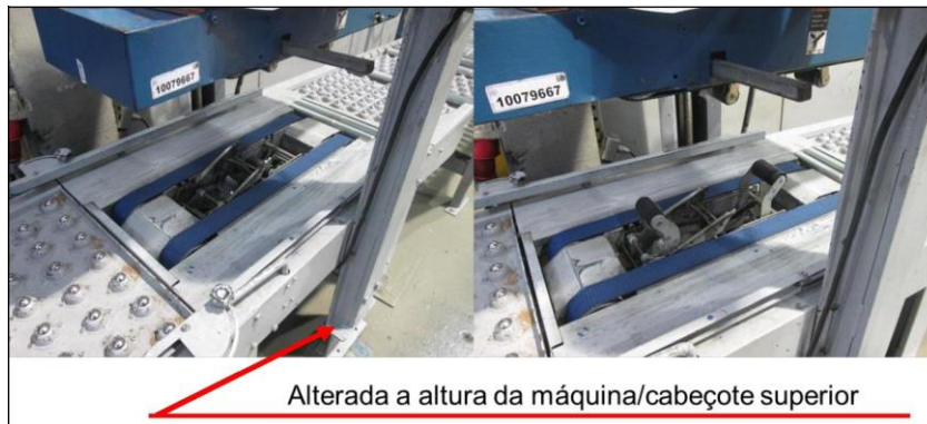
Figura 11 - Máquina de selar caixa de papelão com alteração na altura Fonte: Autoria própria.
