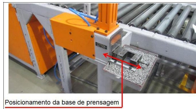
Figura 15 – Prensa para pré-posicionar rebite na placa de identificação do motor Fonte: Autoria própria.
