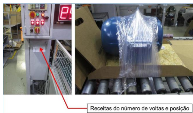
Figura 14 – Receita da máquina de passar filme stretch Fonte: Autoria própria.
