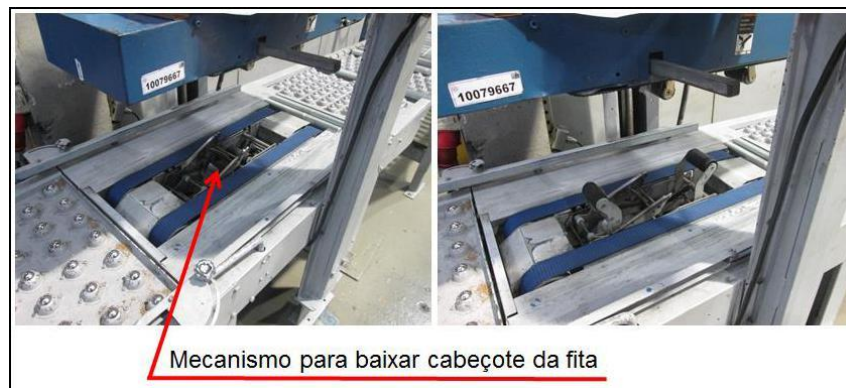
Figura 12 - Máquina de selar caixa de papelão com alteração no cabeçote inferior Fonte: Autoria própria.
