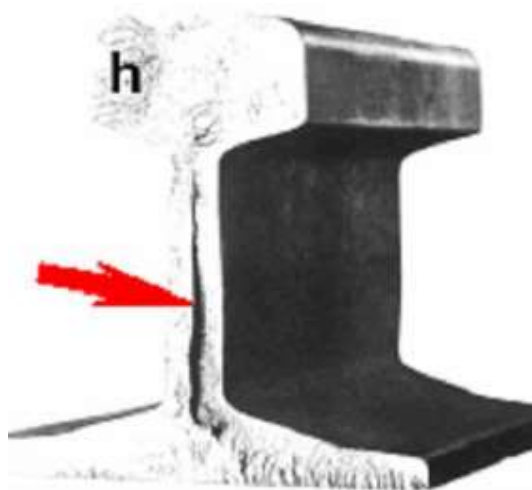
Fotografia 8 – Trinca vertical na alma em junta/fora da junta
