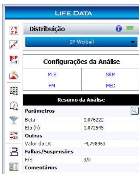
Figura 20 – Distribuição de Reparo - Modo de falha 01
