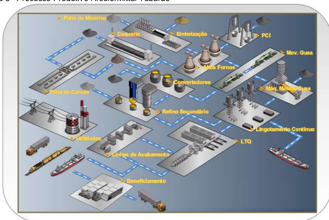
Figura 6– Processo Produtivo ArcelorMittal Tubarão
