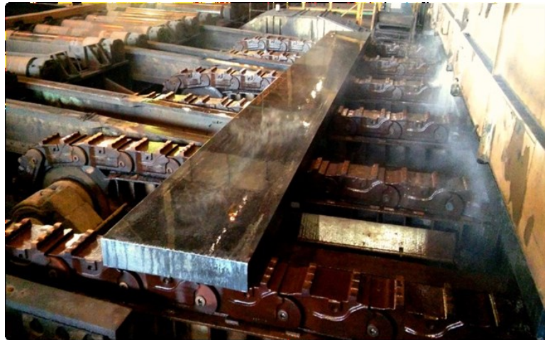
Fotografia 2.1 Entrada do Resfriador e suas Correntes
