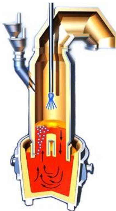
Figura 1.2 - Visualização Seccional de um Vaso de RH com lança T-Cob
