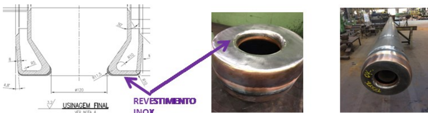
Figura 4.14 – Implantação de melhoria revestimento do bico inox 309L
