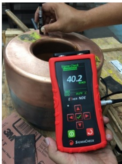
Figura 4.13 – Medição de condutividade térmica do padrão no bico novo
