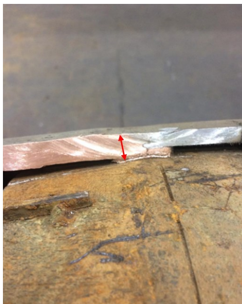
Figura 4.11 – Espessura inadequada de fabricação do bico com obstrução fluxo água de refrigeração
