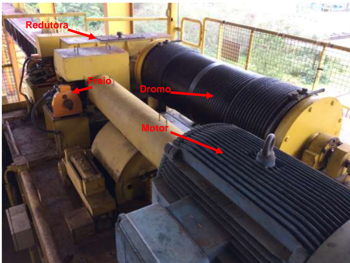
Fotografia 2.6 – Sistema de Elevação – Motor, Redutora, Freio e Dromo
