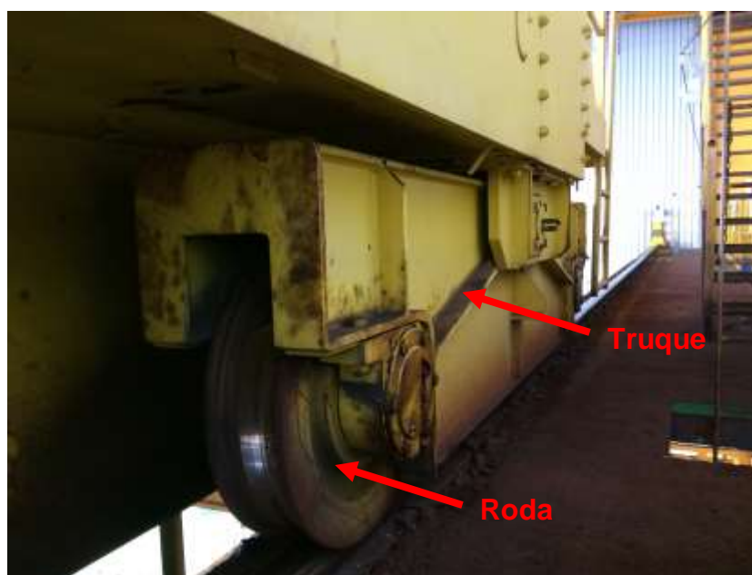
Fotografia 2.2 – Sistema de Translação da Ponte – Rodas
