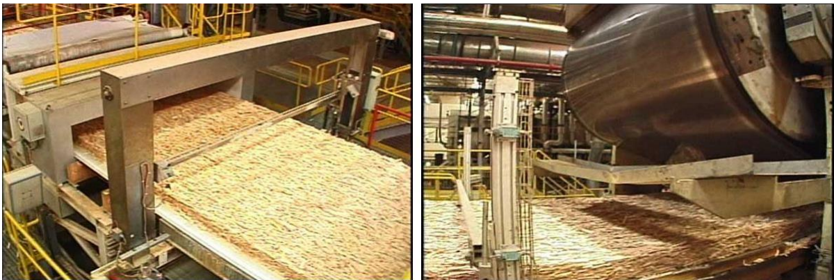
Figura 1 Camada de lascas e a entrada da prensa
