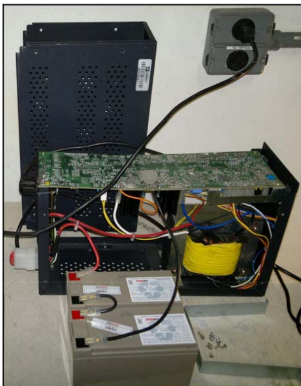
Figura 1 – Troca de baterias de nobreak de 1200 VA
