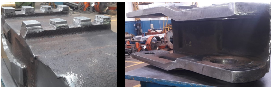
Figura 7.1 – Restauração com solda dos componentes
