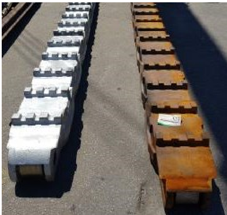
Figura 7.3 – Segmentos montados com conjunto de 12 elos
