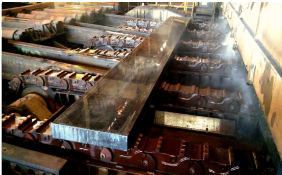
Figura 2. 6 – Vista do Carregamento da Placa no Resfriador de Placas
