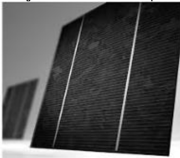
Figura 6 – Células fotovoltaicas de p-Si
